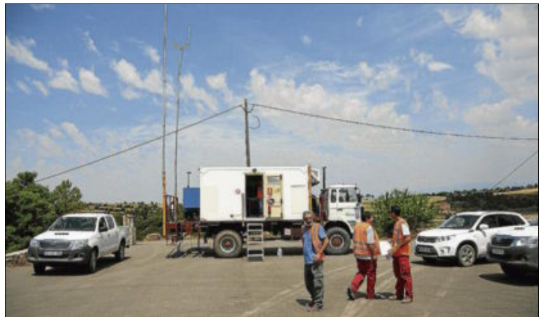
Laboratori mòbil on es reben les dades i on es controla que tots els dispositius funcionin correctament
