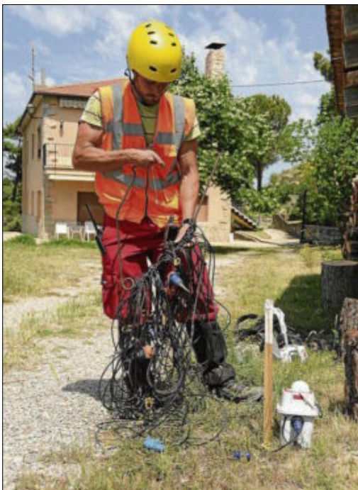
Instal·lació de geòfons a tocar de l'observatori de Castelltallat
